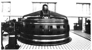
Figure 3. Alternateur synchron de 1850 kVA datant de 1910.
