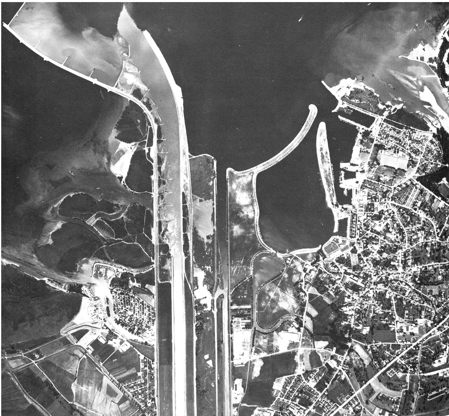
Bild 5.14. Flugaufnahme der Rheinmündung. Das Bild ist wie eine Landeskarte orientiert, Norden ist oben. Zwischen Dämmen und Buhnen fliesst der korrigierte Rhein in die Fussacher Bucht. Parallel dazu, rechts, mündet die Dornbirnerach. Im Bild rechts die Mündung der Breitenzerach. Swissair Foto und Vermessungen AG
