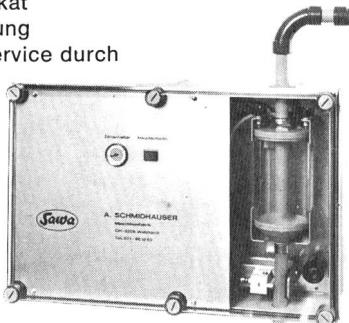
zur vollständig automatischen Entnahme von Abwasserproben in Kläranlagen und Industrie zeit- oder mengenproportionale Entnahme mit Einfrierschutz und Rückspülung.
