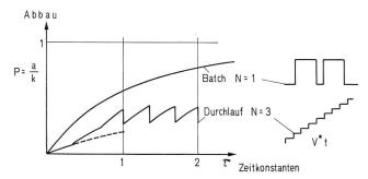
Bild 1. Der Abbau im Batchprozess sowie im intermittierenden Durchlaufverfahren mit 3 Chargen zur Auffüllung des Reaktorinhalts  $V_{\rm R}$ .
