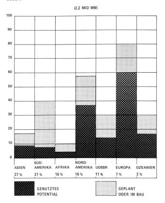
Bild 1. Das wirtschaftlich nutzbare Wasserkraftpotential der Erde.
