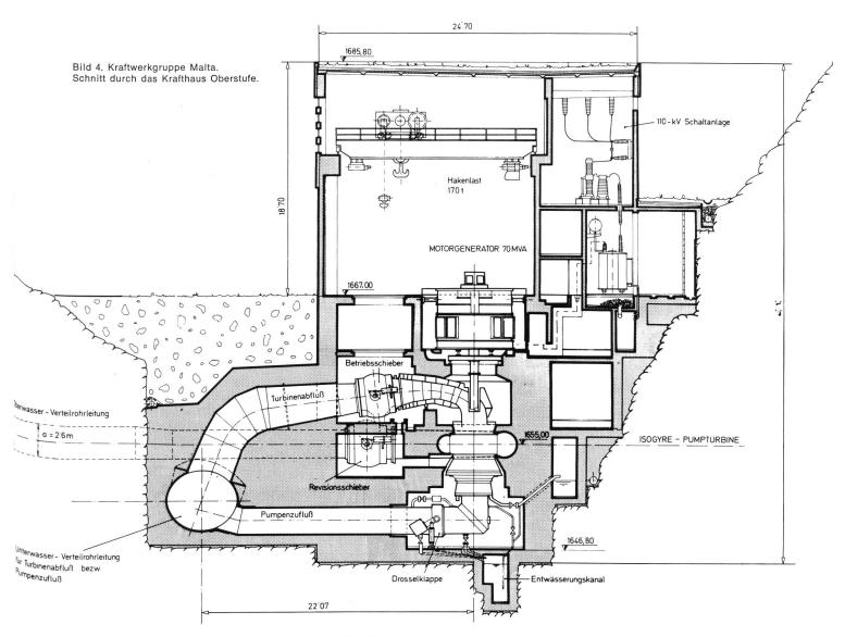
Die beiden Maschinensätze der Oberstufe (Bild 4), vollständig von der Schweizer Industrie geliefert, sind technische Besonderheiten «par excellence». Die Pumpturbinen von Charmilles sind die grössten bisher gebauten Isogyremaschinen und leisten im Turbinenbetrieb je 62,8 MW bei 500 U/min.
