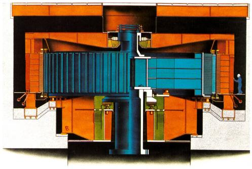
Bild 10. Kraftwerk Itaipu/Brasilien-Paraguay. Schnitt durch den Generator.
