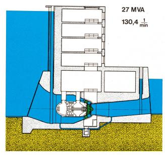
Bild 7. Rohrturbinen-Motorgeneratoren. Längsschnitt der Anlage Granadilla in Spanien.
