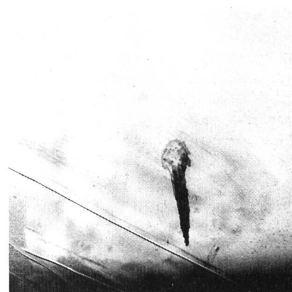
Bild 5. «Bitumenprobe» nach dem ersten Sandstrahlen. Mit einem Toluol getränkten Wattebausch wurde das nach dem ersten Sandstrahlen noch vorhandene Bitumen nachgewiesen.
