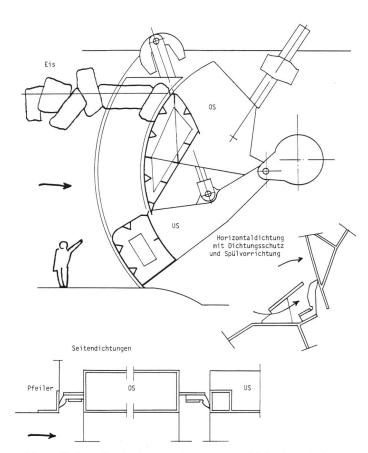
Bild 20. Eis-Retentionsbecken an der Sihl bei Zürich. Querschnitt durch die Doppel-Segmentschütze, unten die Seitendichtungen.
