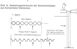
Bild 15. Gestaltungsmerkmale bei Nadel-Notverschlüssen.
