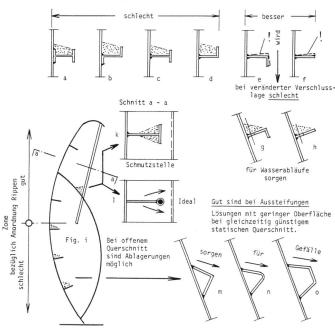
Bild 16. Konstruktionsmerkmale.
