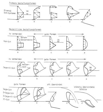
Bild 13. Gestaltungsmerkmale bei Wehrverschlüssen. Gestalten geht vor Konstruleren; die konstruktiven und die korrosionsschutztechnischen Anforderungen müssen dazu bekannt sein und sind zu berücksichtigen.
