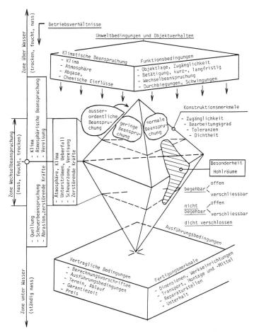
Bild 10. Darstellung der Einflüsse auf die konstruktive Gestaltung von Stahlwasserbauten in Form eines Bi-Tetraeders.
