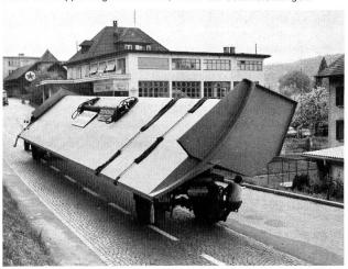
Bild 23. Stauwehr Aarau. Transport einer der vier Segmentschützen
