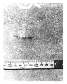
Bild 7, links. Beschichtung mit Montageverletzungen. Eine Kratzspur zeigt bereits Korrosion.
