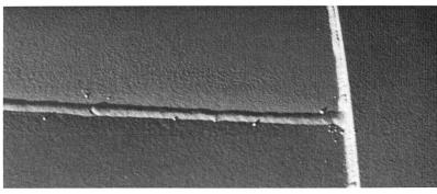
Bild 1. Die Schweissperlen werden erst nach Strahlung und Beschichtung richtig erkenntlich, aber wer entfernt sie dann noch? Der Hersteller des Werkstückes ist ja oft nicht mehr erreichbar.
