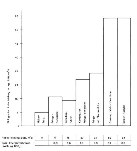
Bild 5. Vergleich von Belüftungsgeräten und Fermentern
