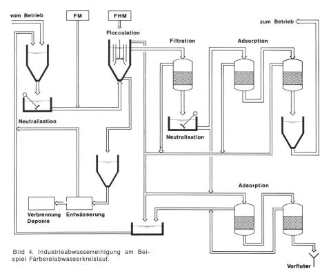
stung von grosser Bedeutung. Getrennt anfallende, farbstoffhaltige Abwässer können beispielsweise durch Adsorption behandelt werden. Dies wird veranschaulicht mit Bild 4. Auch in diesem Beispiel ist eine 100 % ge Kreislaufführung nicht möglich. Etwa 20 % des Produktionswassers werden durch Frischwasser ersetzt.
