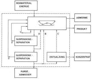
PRODUKTIONSANLAGE - RÜCKGEWINNUNGSEINHEITEN.
