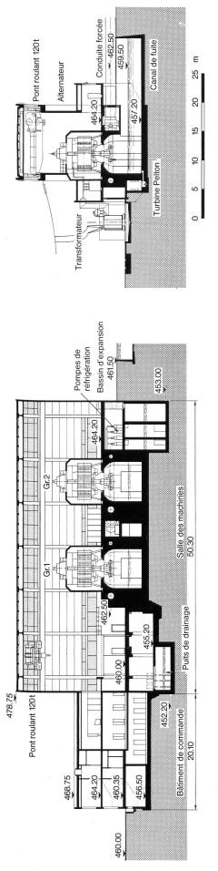
Figure 1. Centrale de La Bâtiaz, poste de couplage et bassin d'expansion: Situation et coupes.
