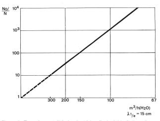
Figure 3. Taux de mortalité des bactéries Escherichia-Coli en fonction du débit d'eau. Les taux de mortalité ont été mesurés avec une lampe UV-C qui avait déjà 1000 heures de fonctionnement.
