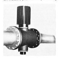
Figure 1. Emetteur UV-C utilisé pour l'installation de stérilisation d'eau qui atteint un rendement de 99,9 % pour un débit de 100 m³/h et une teneur en bactéries de 10°/ml.
