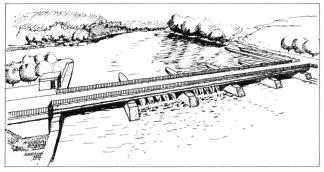
Als Ersatz für die heutige Kahnrampe wird linksufrig eine betrieblich vorteilhaftere Kahnschleuse von 22 m Länge und 4,50 m Breite eingebaut, die ein bedeutend schnelleres Auf- und Abschleusen der Schiffe ermöglichen wird. Ein Senktor am Oberhaupt und ein Stemmtor am Unterhaupt schliessen die Schleuse ab. Es ist eine Anlage für die vollautomatische Schleusung der Schiffe vorgesehen. Die Befehle zur Schleusung und die Überwachung erfolgen vom Kommandoraum der Zentrale Beznau aus.
