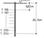
Bild 5. Messstelle 602. Einfluss der Sandfüllung im Piezometerrohr auf die gemessenen Grundwassertemperaturen.
