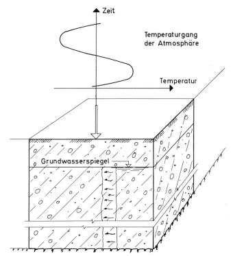
Bild 8. Rechenmodell für die Behandlung des Wärmeaustausches mit der Atmosphäre.
