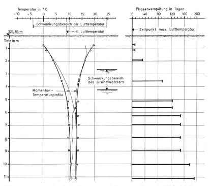
Bild 13. Gemessene Amplitudendämpfung und Phasenverspätung in Abhängigkeit von der Tiefe. Messstelle 801, 1973.
