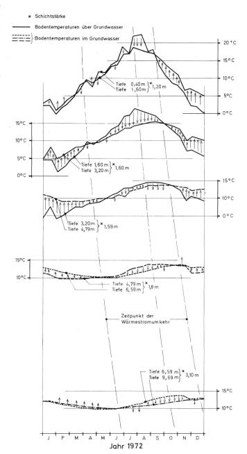
Bild 15. Vertikale Wärmeströme, Messstelle 801, 1972.
