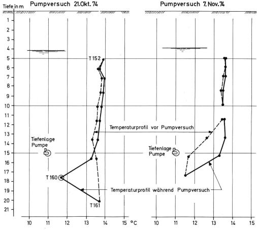
Bild 4. Beeinflussung des vertikalen Temperaturprofils durch Pumpversuche im Piezometerrohr.
