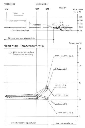
Bild 23. Temperaturprofile im Infiltrationsbereich, 1974.
