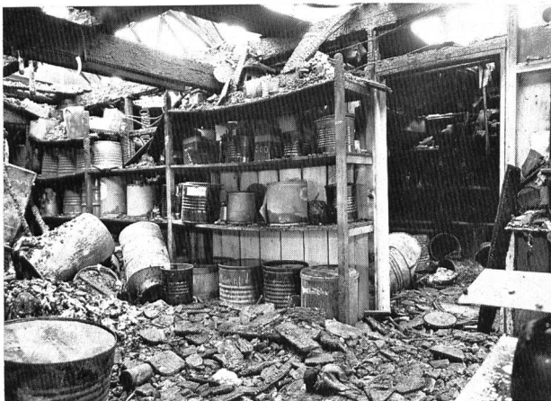
Bild 2. Nach dem Brand eines Textilwerkes: Durch eine vorschriftsgemäße und sichere Lagerung der Chemikalien kann eine Verschmutzung der Gewässer weitgehend verhindert werden.
