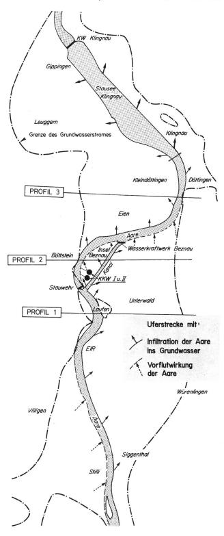
Bild 3. Beziehungen zwischen Aare und Grundwasser.
