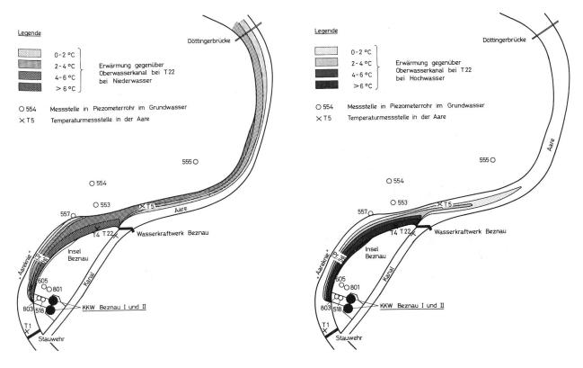
Bild 10. Die Erwärmung der Aare bei Vollast des KKB, links bei Niederwasser der Aare am 17. 10. 75, rechts bei Hochwasser der Aare am 18. 4. 76
