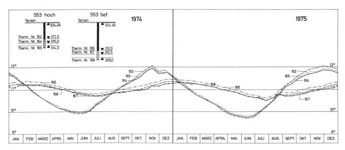
Bild 9. Ganglinien von je 3 Thermometern an den Rohren «553 hoch» und «553 tief». «Scharfe» Temperaturschichtung; «inverse» Schichtung jeweils von Februar bis Juli.
