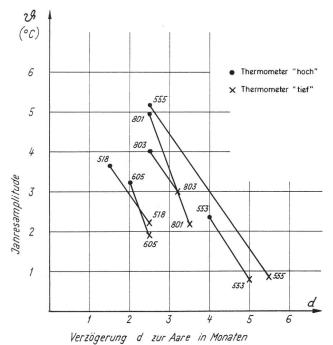
Bild 5. Jahresamplituden  $\vartheta$  des Grundwassers (in °C) bei Thermometern «hoch» und «tief» am selben Rohr in Funktion der Verzögerung d zur Aaretemperatur (in Monaten).
