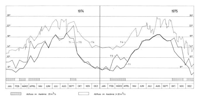
Bild 11. Ganglinien der Aaretemperatur T 1 oberhalb der Kühlwasser-Rückgabe,
