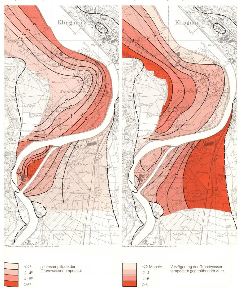
tinger Brücke und schliesslich beidseits des Stausees Klingnau. Längs dieser Infiltrationsstrecken reichert die Aare durch Flusswasserinfiltration das Grundwasser an und beeinträchtigt dadurch dessen chemische Eigenschaften.
