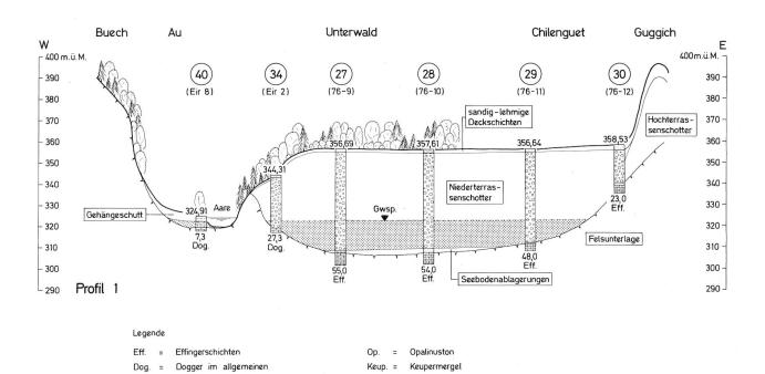
Bild 2. Geologische Querprofile durch das unterste Aaretal (Profilspuren siehe Bild 3).
