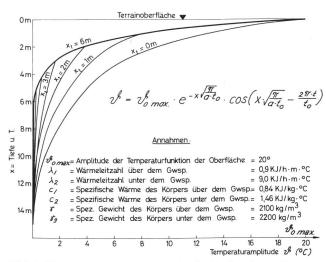
Bild 6. Dämpfung der Jahresamplitude  $\vartheta$  der Grundwassertemperatur in Funktion der Tiefe unter Terrain x für verschiedene Trokkentiefen  $\mathbf{x}_{\mathbf{t}}$  (nach E. Gröber 1955).
