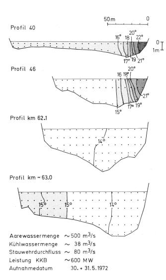
Bild 7. Temperaturquerschnitt durch die Aare im Messbereich Beznau bei mittlerer Wasserführung. Die zwei obern Temperaturquerschnitte zeigen den zonierten Abfluss im Aareknie, die beiden unteren Querschnitte den nahezu homothermen Abfluss unterhalb des Wasserkraftwerks Beznau.
