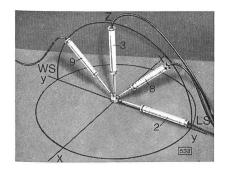
Bild 2. Teleformeter zur Messung von Dehnungen.
