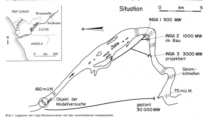
(Bild 1) zeigt, wird auch noch nicht das ganze Gefälle ausgenützt.
