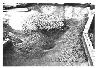
Bild 8. Seitliche Schüttung mit 4-t-Material, rauhe Uferoberfläche.
