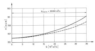
Bild 3. Kapazitätsfunktion der Entlastung (gestrichelt: Dammdurchfluss addiert).
