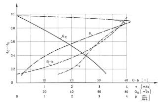
Bild 10. Gerechnete Funktionen des reduzierten Abflusses  $Q_{R^i}$  der Dammlänge B — b, der spezifischen Beanspruchung p sowie der maximalen mittleren Geschwindigkeit in Funktion des Anstiegs des Oberwasserspiegels für das Anwendungsbeispiel.
