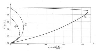
Bild 4. Spezifische Beanspruchung in der Querschnittskontraktion, bei gleichmässiger Schüttung 1, unter Berücksichtigung des Dammdurchflusses 2 und bei seitlicher Schüttung 3.
