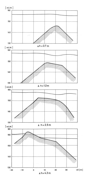
Bild 5. Entwicklung der Dammgeometrie bei gleichmässiger Schüttung für Blöcke von 0,3 t mittleren Gewichts.
