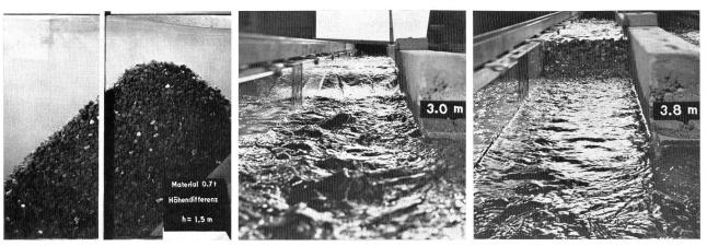
Bild 6. Gleichmässige Schüttung in einer Laborrinne, seitliche und Unterwasseransicht, Blockgewicht 0,7 t, Wasserspiegeldifferenz 1,5 m (links), 3,0 m (Mitte) und 3,8 m (rechts).
