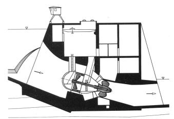
Bild 7. Schnitt durch einen Donau-Staudamm mit liegender Kaplan-Rohrturbine.
