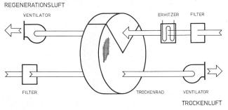
Bild 10. Schema der kontinuierlichen Adsorptions-Entfeuchtung nach dem Munters-Prinzip.
