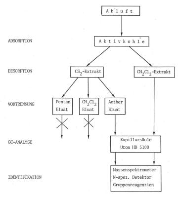
Bild 1. Schematische Darstellung des Analysenganges.
