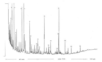
Bild 4. Gaschromatogramm des Aether-Eluats einer Abluftprobe aus dem Schlammeindicker Werdhölzli (Strukturvorschläge siehe Tabelle 2).
