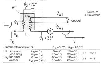
Bild 2. Nachpasteurisierung mit direkter Wärmekoppelung über Hochtemperatur-Wärmetauscher.
