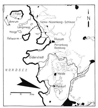
Bild 1. Massnahmen des Generalplans an der Westküste Schleswig-Holsteins. Der Pfeil bezeichnet die Abdammung der Dithmarscher Bucht. Die vorhandene Deichlinie ist mit dünnen, durchgehenden Linien angegeben. Die verkürzte Deichlinie ist dick gestrichen. chelt gezeichnet und die noch zu verstärkenden Deiche sind stark ausgezogen angegeben.
