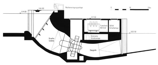
Bild 4. Schnitt durch den Maschinentrakt des Kraftwerkes Maienfeld im Massstab 1:500.
