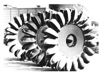
Figure 1. Roues Pelton (poids unitaire 6 t) coulées dans les fonderies d'acier Sulzer pour l'usine hydro-électrique «Santo Domingo» au Venezuela.
