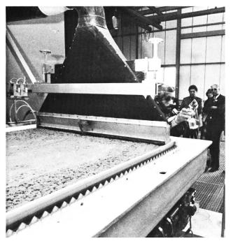
Bild 3. Eine der beiden Strassen der Elektroflotationsanlage.
