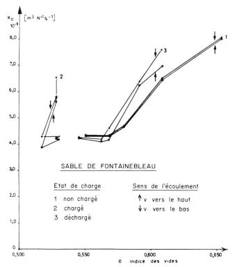
Figure 11. Coefficient de perméabilité en fonction de l'indice des vides pour 3 cas de charge dans les 2 sens d'écoulement.
