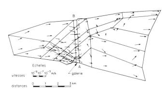
Figure 15. Massif de Trient: Coupe horizontale passant par la galerie A—B. Champs des vitesses de Darcy calculées par le modèle TRIDIH après ajustement des perméabilités à partir des données thermiques et hydrauliques, voir aussi figure 5. (D'après Favrod, Jamier, et Menjoz dans [3].)
