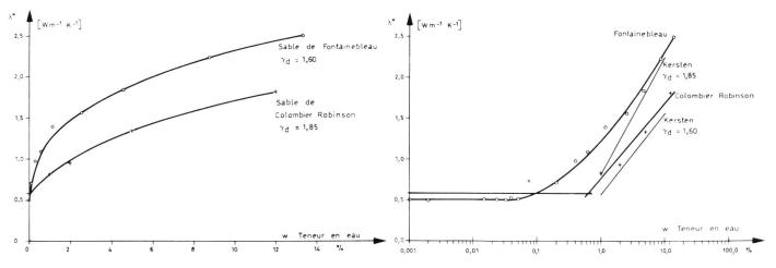
Figure 13. Conductivité thermique  $\chi$  en fonction de la teneur en eau ( $\gamma_d$  = densité apparente).
