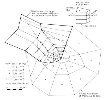
Figure 20. Nappe de Colombier-Robinson. Coupe horizontale au niveau P<sub>5</sub> du réseau d'éléments avec jonction d'un sous réseau destiné à améliorer la précision des solutions numériques. Une augmentation de la densité des éléments dans la zone du puits (non représentée) est également réalisée (d'après Favrod, Jamier, et Menjoz dans [3]).
