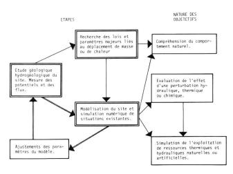
Figure 1. Représentation schématique des étapes conduisant à la réalisation des objectifs envisagés pour l'étude des transferts de masse et de chaleur.
