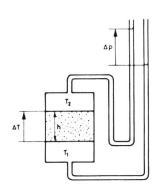
Figure 14. Représentation schématique du dispositif de mesure du coefficient de thermo-osmose  $\rm K_{
