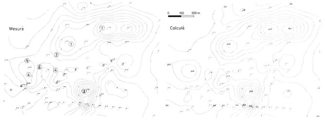
Figure 6. Nappe de la raffinerie de Cressier. Isothermes de la nappe mesurées et calculées par le modèle mathématique. +puits de pompage; 1. fours; 2. torchères basses; 3. réservoirs 80 °C; 4. réservoirs 130 °C; 5. réservoirs 200 °C; 6. réservoirs 25 °C.
