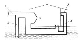
Energieflussschema eines Hallenbades mit Wärmerückgewinnung und Wärmeentnahme aus Grundwasser. 1 Elektrische Energie Verdichter, 2 Wärme aus Grundwasser, 3 Wärme aus Fortluft, 4 Wärme aus Abwasser, 5 Wärmezufuhr zum Hallenbad.
