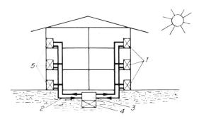
Bild 11. Bau mit integrierter Heizung. 1 Kleinwärmepumpen süd, 2 Kaltwasserverteilsystem, 3 Speicher, 4 Zusatzheizung, 5 Kleinwärmepumpen nord.
