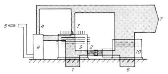
Bild 12. Totalenergie. 1 Treibstoff, 2 Kraftübertragung, 3 Kühlwärme, 4 Abgaswärme, 5 Auspuffgase, 6 Wärmequelle, 7 Totalwärme, 8 Abhitzekessel, 9 Kraftstoffmotor, 10 Wärmepumpe.
