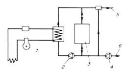
Bild 9. Schematische Darstellung der hydraulischen Kreise einer Wärmepumpenheizung. 1 Wärmepumpe, 2 Ladepumpe, 3 Speicher, 4 Umwälzpumpe, 5 Heizungsvorlauf, 6 Heizungsrücklauf.
