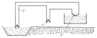
Bild 4. Energieflussschema einer Wärmepumpe. 1 Elektrische Energie Verdichter, 2 Wärme aus der Wärmeguelle, 3 Nutzwärme,
