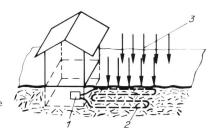
Spatenstichtiefe unter die Erdoberfläche zu legen, um einen möglichst kleinen Wärmewiderstand zwischen Erdoberfläche und Verdampfer zu erhalten. Die Erdoberfläche als Konvektor hat noch einen Vorteil: Bei Temperaturen um 0 °C diffundiert das Kondenswasser aus der Luft in die oberste Erdschicht bevor es gefriert und bildet damit keine kompakte, den Wärmeübergang hindernde Eisdecke.
