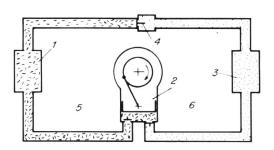
Bild 2. Kreislauf einer Wärmepumpe. 1 Verdampfer, 2 Verdichter, 3 Verflüssiger, 4 Entspannung, 5 Niederdruckseite, 6 Hochdruckseite.
