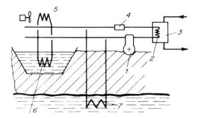
Bild 5. Wärmequellen für Freibäder. 1 Verdichter, 2 Verflüssiger, 3 Wärmetauscher, 4 Ventil, 5 Luft, 2 Verflüssiger, 3 Wär 6 Fluss, 7 Grundwasser.
