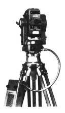
Bild 1, links. Das elektrooptische Distanzmessgerät DM 501, auf das Fernrohr des Sekundentheodolits DKM 2-A aufgesetzt. Am Stativ das Speisegerät mit Ladeteil. Das Speisekabel führt zum feststehenden Theodolitunterteil und behindert deshalb die freie Bewegung des Instrumentes nicht.
