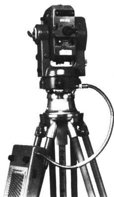
Bild 1, links. Das elektrooptische Distanzmessgerät DM 501, auf das Fernrohr des Sekundentheodoliten DKM 2-A aufgesetzt. Am Stativ das Speisegerät mit Ladeteil. Das Speisekabel führt zum feststehenden Theodolitunterteil und behindert deshalb die freie Bewegung des Instrumentes nicht.
