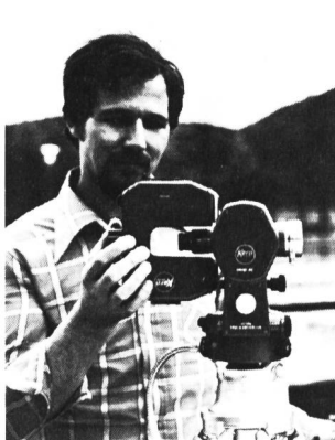
Bild 1, links. Das elektrooptische Distanzmessgerät DM 501, auf das Fernrohr des Sekundentheodoliten DKM 2-A aufgesetzt. Am Stativ das Speisegerät mit Ladeteil. Das Speisekabel führt zum feststehenden Theodolitunterteil und behindert deshalb die freie Bewegung des Instrumentes nicht.
