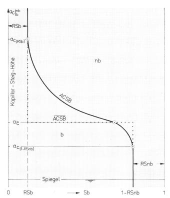
Bild 2. Prinzipskizze einer Kapillar-Steig-Höhen-Kurve, ACSB.
