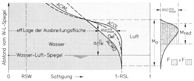
Bild 3. Konzept zur Bestimmung der minimalen Oel-Lachen-Mächtigkeit.
