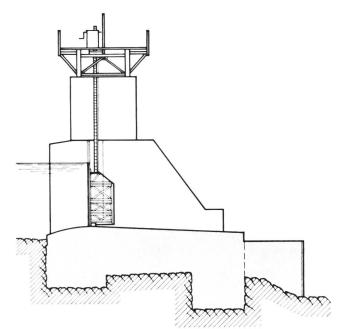
Bild 5. Erneuerung der Wasserkraftanlage Aue bei Baden. Querschnitt durch das alte (links) und das neue Wehr, rechts [4].
