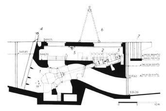
Bild 6. Querschnitt durch das Maschinenhaus des Kraftwerkes Kappelerhof 1:500. 1 Kaplan-S-Rohrturbine, 60 m³/s, 2800 kW, Nettogefälle 5,15 m. 2 Planetengetriebe, 86,3/750 U/min. 3 Generator, 3300 kVA. Automatische Rechenreinigungsmaschine. 5 Deckenlaufkran 2 t. 6 Portalkran 25 t. 7 Dammbalkenlager [5].
