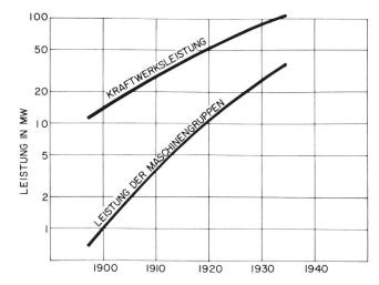
Bild 1. Entwicklung der hydraulischen Kraftwerks- und Maschineneinheitsleistungen im Zeitraum von 1900 bis 1930 (Schweiz).
