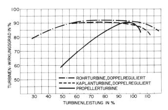
Bild 2. Vergleich des Wirkungsgrades für Propeller-, Kaplan- und Rohrturbine.
