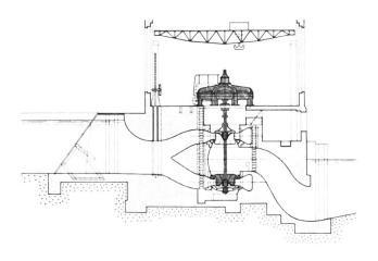
Bild 4. Maschinenhausquerschnitte des alten und des erneuerten Werkes Aue in Baden. In den Jahren 1965/66 wurden zwei vertikalachsige Zwillings-Francisturbinen durch Rohrturbinen mit leicht geneigter Achse ersetzt. Dadurch konnte die installierte Leistung von 2950 kW auf 3900 kW, die jährliche Energieabgabe von 18,7 GWh auf 26 GWh gesteigert werden [4].
