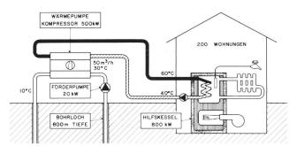
Bild 2. Schema einer geothermischen Wärmeversorgnung.
