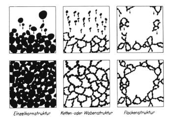
Bild 1. Entstehung der verschiedenen Bodenstrukturen. Aus Kollbrunner: Fundation und Konsolidation, Bd. I, S. 37.
