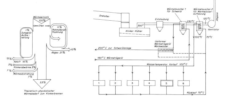
Bild 1, links. Wärmeflussdiagramm eines modernen Trockenofens: Vom Wärme-Input werden rund 53 % für die Umwandlung des Rohmehls in Klinker benötigt (= theoretisch-physikalischer Wärmebedarf). Die restlichen 47 % verlassen den Ofen in Form von Abwärme, welche ihrerseits zu 12 % einer Wiederverwertung (Rohmaterialtrocknung und Schwerölaufbereitung) zugeführt wird.
