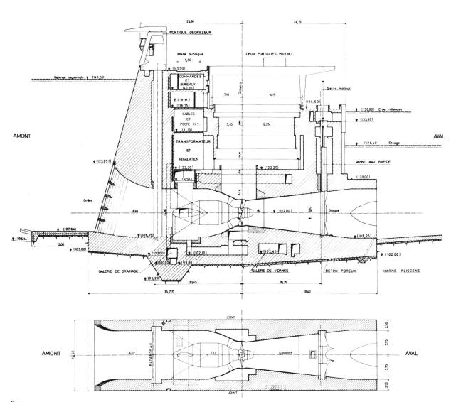
Bild 10. Rhonestufe le Péage-de-Roussillon. Vertikalschnitt durch die Zentrale (oben) und Horizontalschnitt durch eine Rohrturbine (unten), Massstab 1:500.
