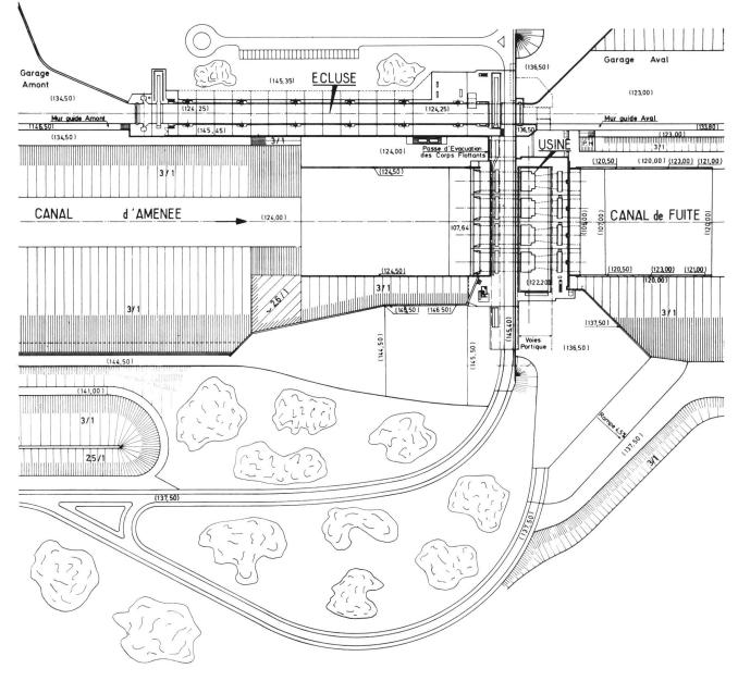
Bild 11. Rhonestufe le Péage-de-Roussillon. Lageplan mit Zentrale und Schleuse, Massstab 1:2000. Figure 11. Aménagement du Péage-de-Roussillon. Plan d'ensemble de l'usine-écluse, à l'échelle 1:2000.
