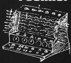
Das maschinelle Rechnen wurde bereits 1623 von Wilhelm Schickard versucht. Seine genial konstruierte Rechenmaschine erlaubte die Durchführung der vier Grundoperationen und besass speichernde Register.
