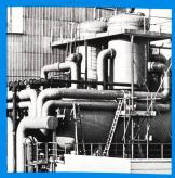
Ionenaustausch-Mischbettanlagen. Für normalen und höheren Druck Hoher Reinheitsgrad.
