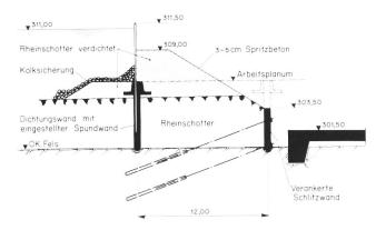
Bild 12. Schnitt C—C durch den Fangedamm Rheinseite. 1:400. Profilspur siehe Bild 6.
