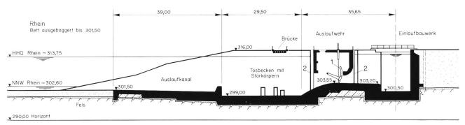
Bild 8. Längenschnitt B—B durch das Auslaufbauwerk im Massstab 1:1000. 1 zwei Segmentschützen 2,7 x 7,75 m; 2 Dammbalken. Profilspur siehe Bild 6.
