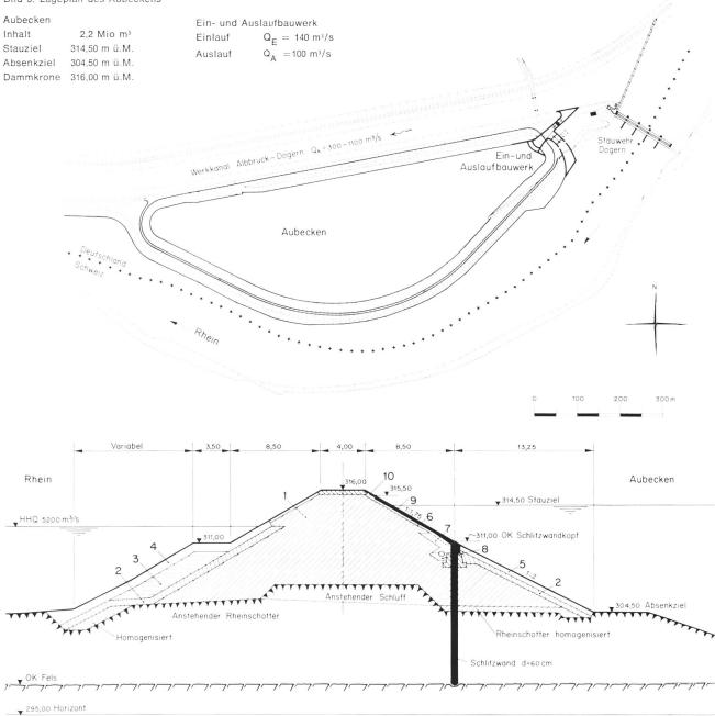
Bild 4. Querschnitt durch den Beckendamm Rheinseite im Massstab 1:400. 1 Rheinschotter, verdichtet; 2 Filter, Durchmesser 5 bis 200 mm; 3 Felsschutt aus vorhandener Deponie; 4 Böschungsschutz Rheinseite; 5 Böschungsschutz 150 bis 300 mm; 6 Brechschotter 0 bis 40 mm; 7 Filter, Durchmesser 5 bis 56 mm; 8 Sand, Durchmesser 0 bis 5 mm; 9 Asphaltbeton, Binder 5 cm, Dichtung 8 cm; 10 Gitterrasensteine.
