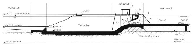
Bild 7. Längenschnitt A—A durch das Einlaufbauwerk im Massstab 1:1000. 1 Betriebsgebäude; 2 zwei Segmentschützen 3,6 x 4,4 m; 3 Rechen; 4 Rechenreinigungsmaschine; 5 Dammbalken. Profilspur siehe Bild 6.
