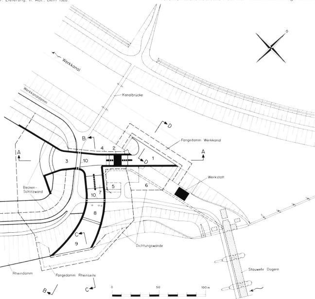
Bild 6. Lageplan Ein- und Auslaufbauwerk im Massstab 1:2000. Einlaufbauwerk: 1 Einlauftrompete; 2 Einlaufwehr und Betriebsgebäude; 3 Tosbecken und Endschwelle; 4 Baugrubenschlitzwand; 5 Dammbalkenlager; 6 Kabelkanal. Auslaufbauwerk: 7 Auslaufwehr; 8 Tosbecken; 9 Auslaufkanal; 10 Brücken. Schnitt A—A siehe Bild 7. Schnitt B—B siehe Bild 8, Schnitt C—C Bild 12 und Schnitt D—D Bild 14.
