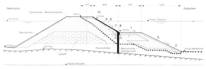
Bild 5. Querschnitt durch den Beckendamm Kanalseite im Massstab 1:400. Legende siehe Bild 4.
