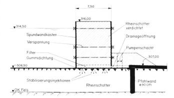
Bild 14. Schnitt D—D durch den Fangedamm Werkkanal, 1:400. Profilspur siehe Bild 6.
