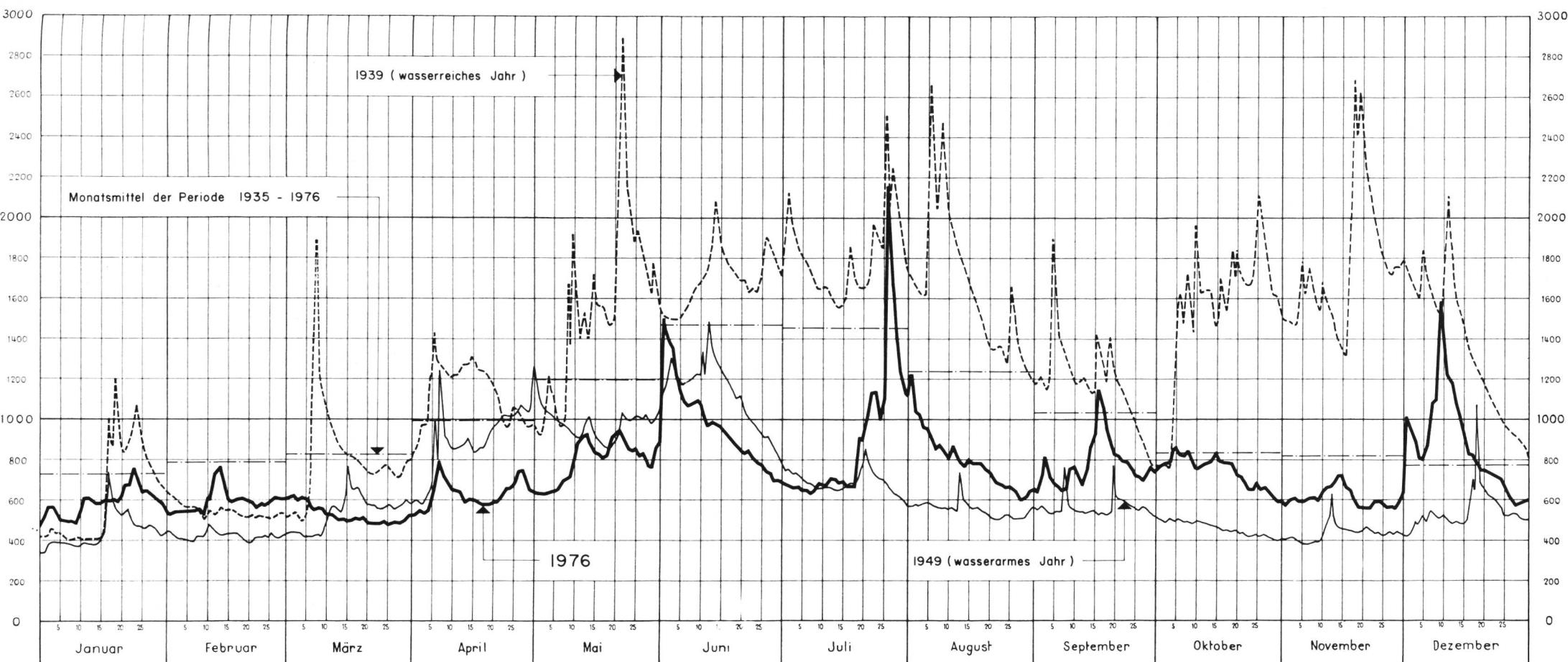
I. Abflussmengen des Rheins bei Rheinfelden. Einzugsgebiet 34 550 km<sup>2</sup>; Vergletscherung 1,6 %. Jahresabflussmenge 1935—1976 1014 m<sup>3</sup>/s oder 32,0 10<sup>9</sup> m<sup>3</sup>; Jahr 1976 732 m<sup>3</sup>/s oder 23,1 10<sup>9</sup> m<sup>3</sup>.
