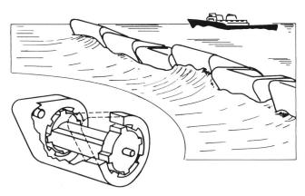
Bild 2. Das «Nodding Duck System» zur Energiegewinnung aus Ozeanwellen (aus «Water Power & Dam Construction», June 1976).
