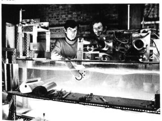
15 m haben und 9 m lang sein. Sie werden zu einer Kette von etwa 500 m aufgereiht, die nicht zu nahe am Ufer, sondern bei einer Wassertiefe von mindestens 90 m verankert wird, damit die grossen Ozeanwellen ausgenützt werden können.
