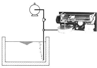
Bild 6. Niveauabtastung mit einer Präzisions-Membrandruckwaage
