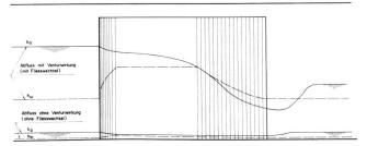
Bild 1. Venturikanal, Abflusshöhen und kritische Tiefen mit und ohne Fliesswechsel.
