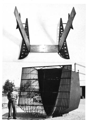
Bild 3. Venturilehren für individuell berechnete Staukörper
