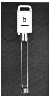
Bild 8 Selbstabgleichendes Referenz-Echolot, Kopf mit Schallwandler, Referenzstrecke in halbgeöffnetem Rohr mit ringförmigem Referenzkörper.
