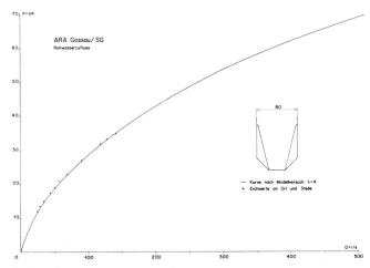
Bild 4. Venturikanal einer Kläranlage, Uebereinstimmung der aus Modellwerten nach Froude umgerechneten Durchflusskurve und Messwerten einer Kontrolleichung für den Trockenwetterbereich an Ort und Stelle.
