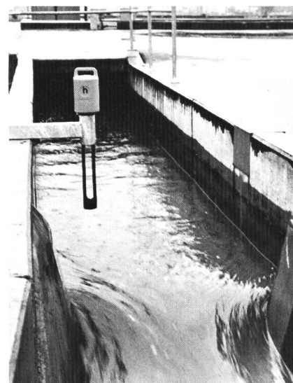
Bild 9. Venturikanal mit eingesetztem Referenz-Echolot.
