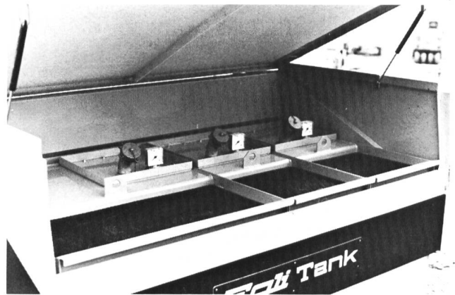
1600-l-Egli-Sammelstelle mit einem Innentank zu 800 l und zwei Innentanks zu 400 l.
