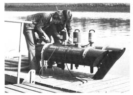
Einsatz eines Flosses für Dauermessungen mit Sonden für O2, pH,  $\varkappa$ , t, Trübung (z. B. in Bayerischen Fliessgewässern)
