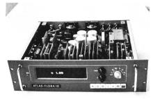
Bild 2. Akustisches Strömungsmessgerät Flora (Deckel entfernt).
