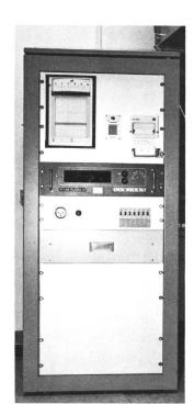
Bild 7. Apparatekasten mit Flora Registrierapparat links oben und Messwertdrucker rechts über Flora.
