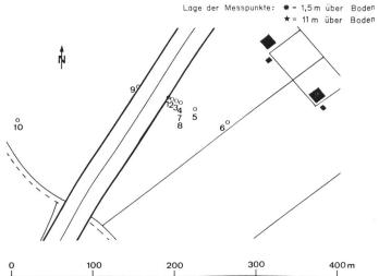
Bild 2d. Autobahn (Oensingen). Die Messpunkte 1 bis 6, 9, 10 liegen 1,5 m über Boden. Punkt 7 liegt 5 m und Punkt 8 liegt 11 m über Boden.
