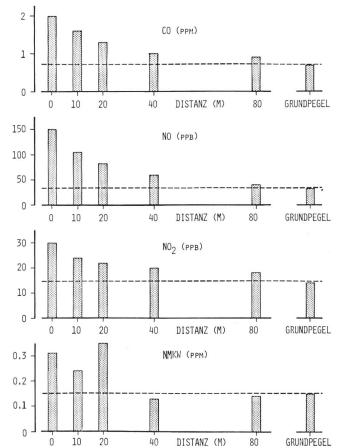
Bild 3c. Autobahn (Oensingen). Die Konzentrationen von CO, NO und NO $_3$  sind auch noch in 80 m Distanz höher als der lokale Grundpegel, weil die Autobahn in weitem Umkreis die einzige Quelle von Luftfremdstoffen ist; die Kohlenwasserstoff-Werte (NMKW) sind durch landwirtschaftliche Quellen beeinflusst.
