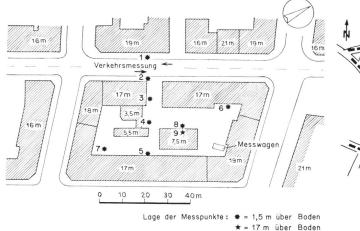
Bild 2a. Strassenschlucht (Langstrasse, Zürich). Die in den Häuserblöcken angegebenen Meterzahlen geben die Höhe der Gebäude an.
