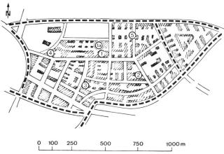
Bild 2c. Wohnquartier (Oerlikon). Gemessen wurde in den Punkten 1 bis 5 in 1,5 m über Boden, im Punkt 1a in 10 m über Boden.
