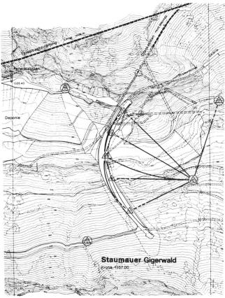
gemessenen Distanzen ist eine Ueberbestimmung vorhanden, die eine Vereinfachung des Triangulationsnetzes gestattet. Die Messpunkte müssen so gewählt werden, dass die Reflektoren gut aufgestellt werden können.
