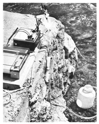
Figure 3. Dispositif de jaugeage composé d'un potentiographe portatif et d'un lon-mètre munis d'une électrode ionique spécifique et d'une électrode de référence. Un équipement de pompage manuelle complète cette installation légère et très mobile sur le terrain. Poids: 6 kg; encombrement: le tout rentre dans un sac à
