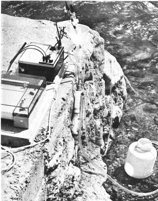
Figure 3. Dispositif de jaugeage composé d'un potentiographe portable et d'un ion-mètre munis d'une électrode ionique spécifique et d'une électrode de référence. Un équipement de pompage manuelle complète cette installation légère et très mobile sur le terrain. Poids: 6 kg; encombrement: le tout rentre dans un sac à dos.
