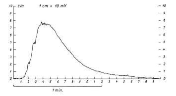
Figure 2. Courbe d'activité de l'ion Na+ enregistrée par potentiographe portatif. L'irrégularité de la courbe traduit la mauvaise répartition du sodium dans le cours d'eau. Le contrôle in situ et en continu permet de détecter l'insuffisance de l'homogénéisation de la substance injectée.
