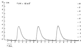
Figure 1. Courbes d'activité de l'ion Na+ enregistrées par potentiographe portatif lors de trois jaugeages successifs exécutés dans conditions identiques (Méthode par intégration). Les courbes traduisent la parfaite reproductibilité de la méthode.
