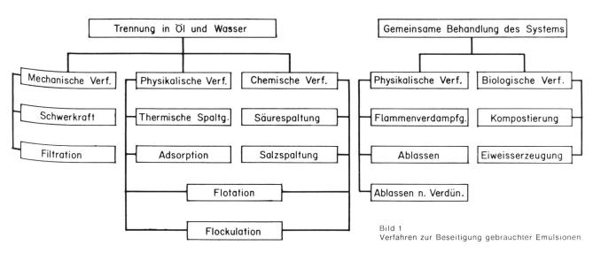
Der rasche biologische Abbau des Mineralöls bei dem Pajab-System wird durch geringe Konzentrationen von Seltenerdmetallverbindungen bewirkt. Während anorganische Salze [20] und Lignosulfonate [21] die Geschwindigkeit der Oxidation von Kohlenwasserstoffen durch Mikroorganismen etwa verdoppeln, beschleunigen Seltenerdmetallverbindungen in bestimmten Konzentrationen den aeroben Abbau ganz entscheidend [22 bis 24].
