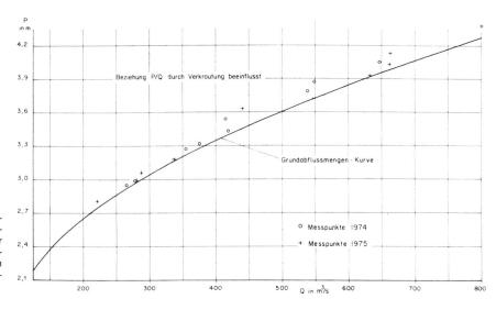
Bild 2. Messstation Rhein-Neuhausen. Abweichung (Streuung) der 9 bzw. 7 Eichmesswertpunkte in den Jahren 1974 und 1975 von der früher gültigen P/Q-Beziehung zufolge Verkrautung. Das Ausmass der Abweichung kann als Pegelstand-Ueberhöhung (in cm) abgelesen werden.
