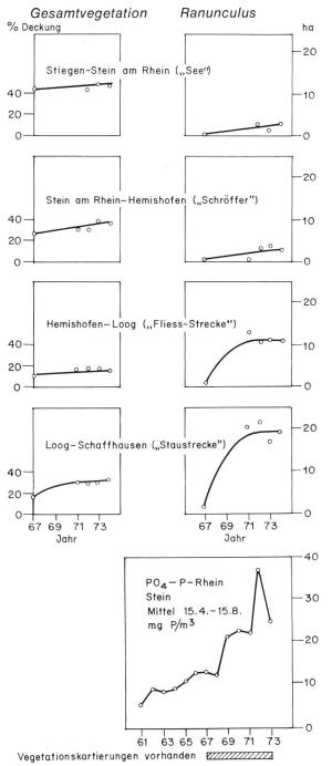
Bild 2. Die Makrophyten-Vegetation im Oberrhein. Nach Zahlen aus [3], J. Bührer, 1976. Links die Gesamtvegetation als prozentuale Dekkung der Flusssohle; rechts die Bedeckung der Flusssohle durch Ranunculus Fluitans in ha. Als Vergleich dazu wird unten die Zunahme der PO4-P-Fracht im Rhein in mg P/m³ gegeben. Die unterschiedliche Ausbreitung des Ranunculus zeigt seit 1971 wenig Veränderungen.
