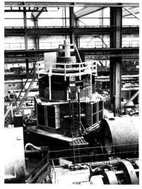
Vertikalachsiger Motorgenerator für Mapragg bei Werkversuchen.
