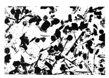
Bild 1. Siebrückstand auf einem 100- $\mu$ m-Sieb, etwa 60mal vergrössert.
